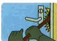
**対策事例** こじ開け防止のために、ガードプレートが設置されたドアの事例です。この他には、ドア上部に別の鍵をつけて二重ロックにすることも時間をかけさせる上で有効な方法だといえます。
