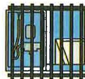
**対策事例** 面格子だけに頼らず、窓にもガラス破りの対策をしておくのが有効だといえます。とくに、面格子の窓では、外出する際にも、空気の入替えをするからと、少し窓を開けたままにしている人が多く、そこから被害にあったという件数が増えており、注意が必要です。
